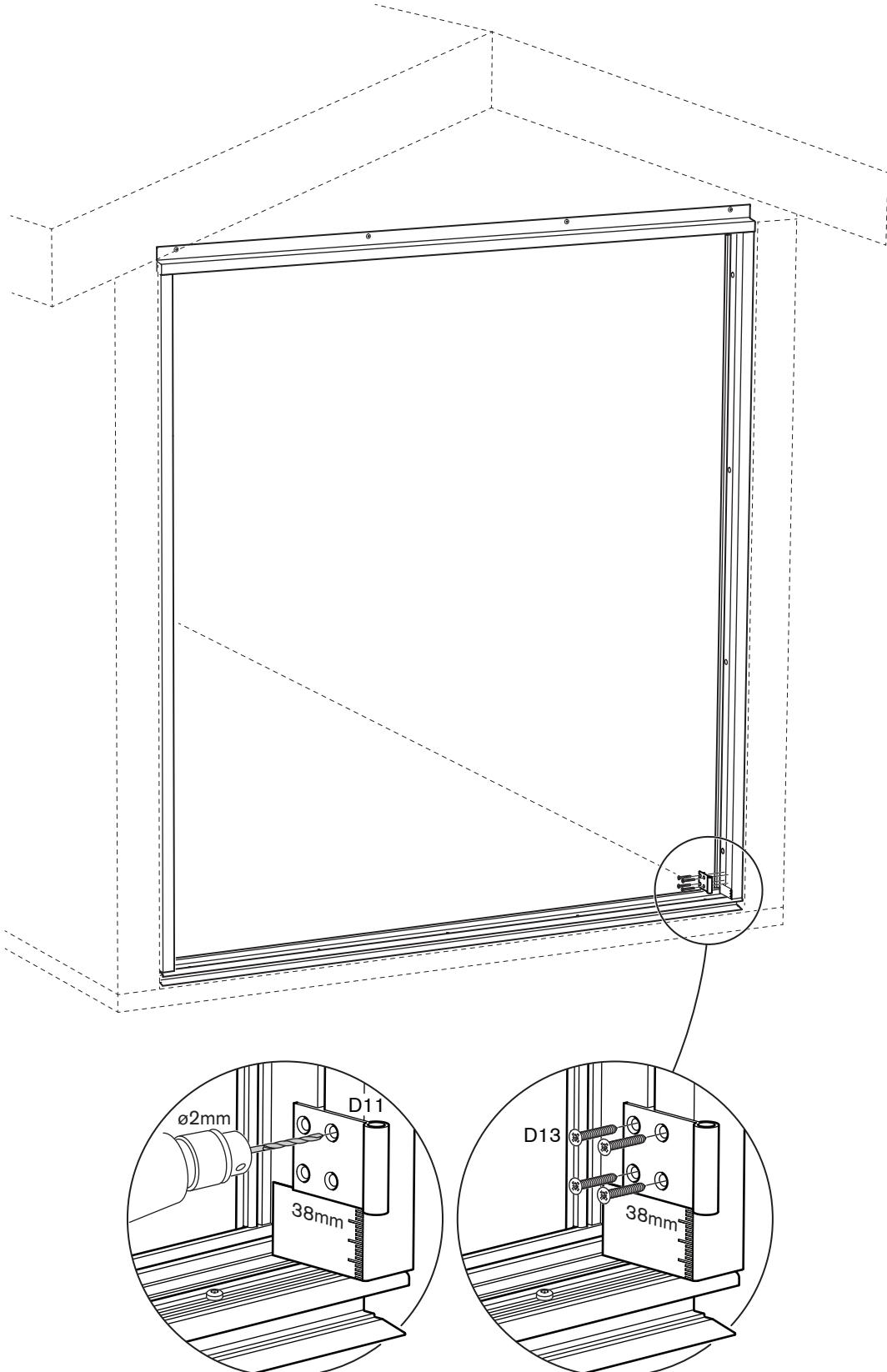
**SE** Skruva fast undre gångjärn på hängningssidan.
