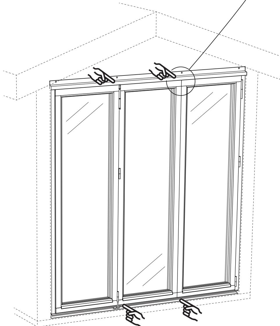
**SE** Börja med att mäta ut centrum på kärmsidan. Borra ett 14mm hål i kärmsidan mitt i spåret. Montera slutblecket D22 med 2st skruv D13. Förborra med 2mm borrh. Justera kärmsidan med kärmskruven tills luckan sluter rätt och tätt.
