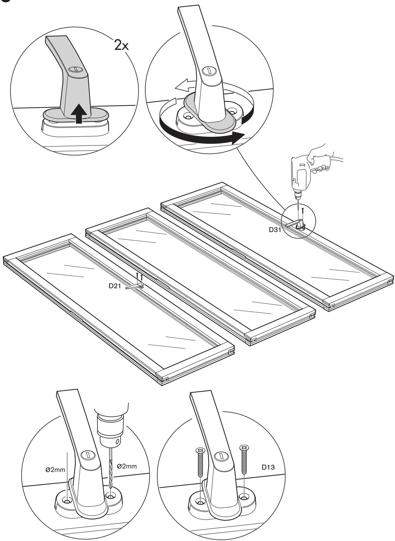
**SE** Montera täcklock D23 med skruv D24 över låskistor på dörr med handtag D21. Förborra med 2mm bor.
